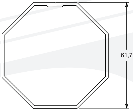
PIT008 | PESO: 0,884 Kg/m Tubo Recolhedor - 60mm
